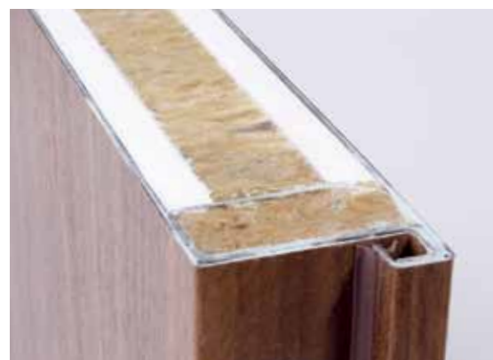
Querschnitt der Türe Economy D1 mit Feuerschutzausführung
